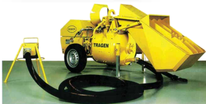
Máquinas de elevação de argamassas
